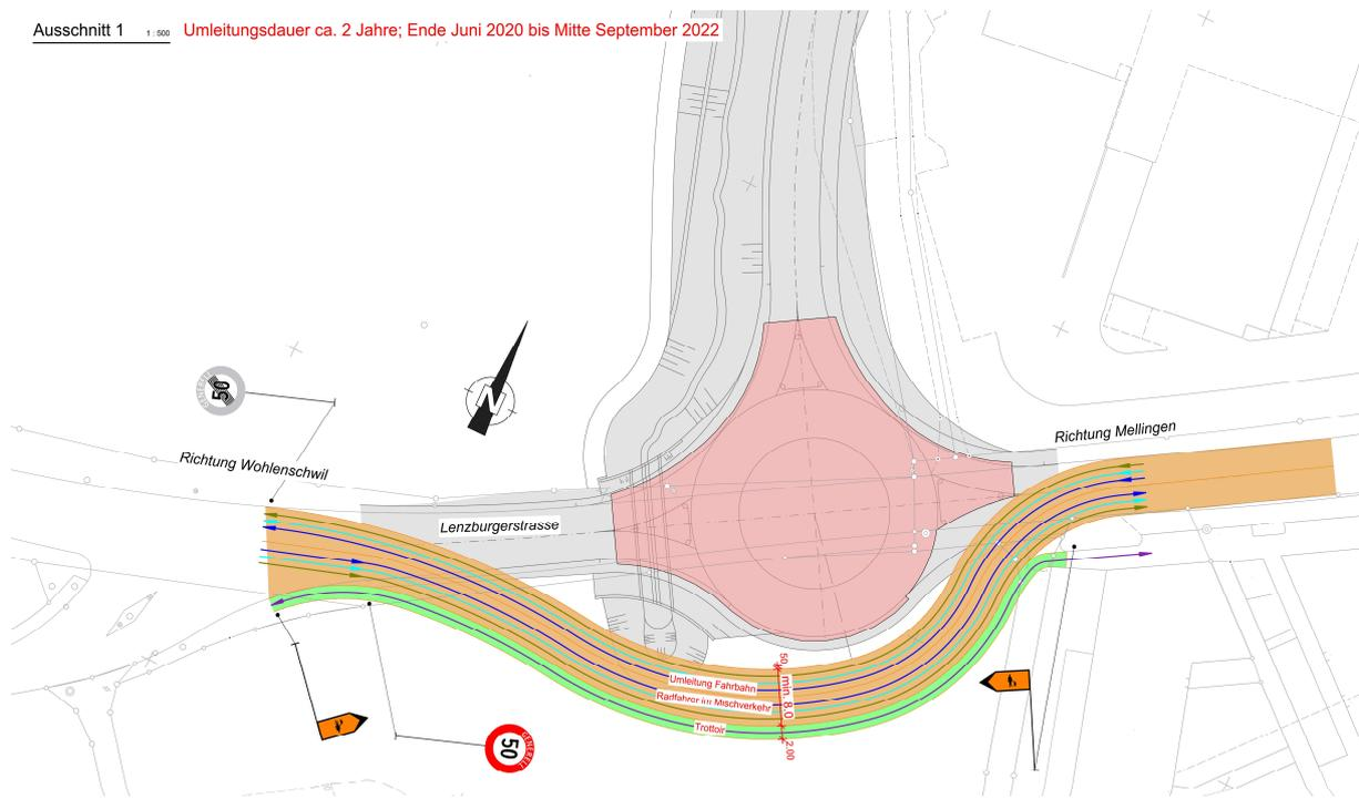
«Der Anschluss der Umfahrungsstrasse an die Lenzburgerstrasse erfolgt über einen neuen Kreisel. Neben diesem Bauwerk müssen noch ein Kleintierdurchlass unter der Lenzburgerstrasse, der Beginn des Franzosengrabens und die Anpassungen an der bestehenden Kantonsstrasse ausgeführt werden.
