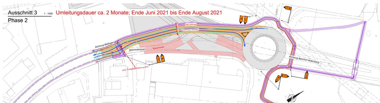
In Phase 2 wird der Anschluss der Bahnhofstrasse an die neue Kantonsstrasse ausgebildet. Dafür müssen die Fahrbahn und der Gehweg der Bahnhofstrasse provisorisch verlegt werden.
